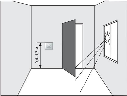
Рисунок 1. Монтаж терморегулятора
