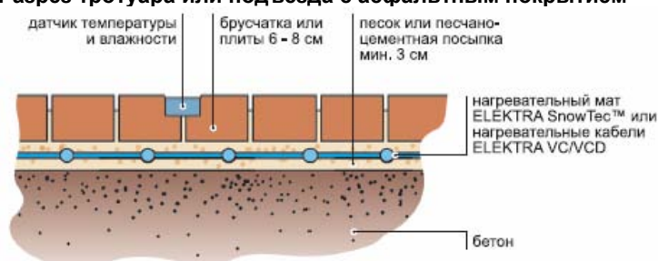
Разрез тротуара или подъезда покрытого плитками или брусчаткой
