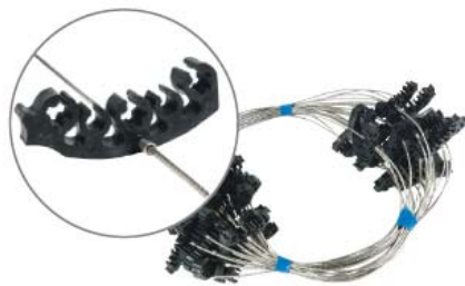
Трос с клипсой для желобов Если длина кабеля введенного в водосточную трубу превышает 12 м, следует применить трос с клипсами.
