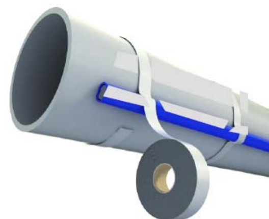
Монтаж кабеля на пластиковой трубе
