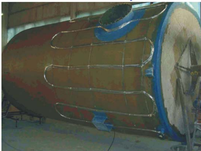
Нагревательные кабели расположенные на резервуаре
