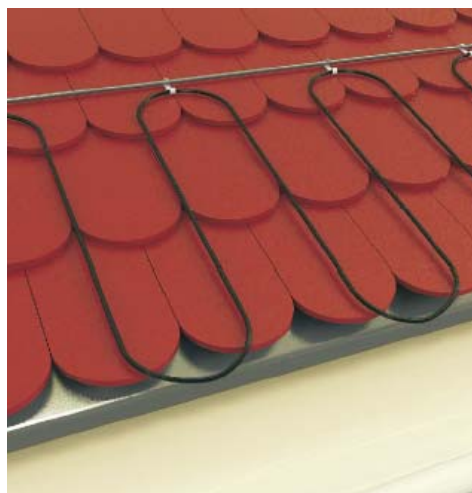
Пример обогрева водосточного желоба и края крыши
