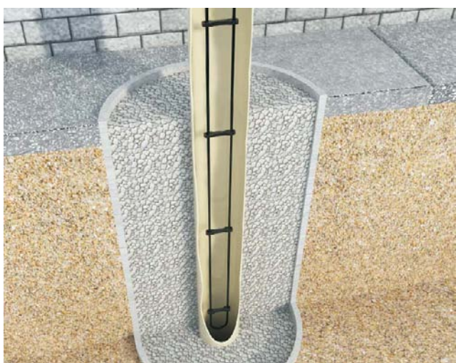
Расположение нагревательного кабеля от уровня земли до глубины промерзания грунта
