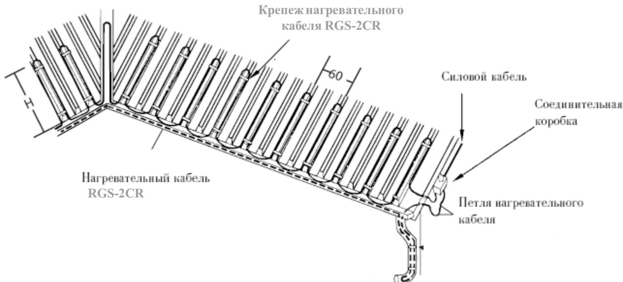
Прикреплять с помощью шурупов , используя уплотнительную прокладку . Расстояние может варьироваться в зависимости от дизайна ребра крыши . Обычно рекомендуется повторить очертания всех ребер (рельефных выступов ) .
