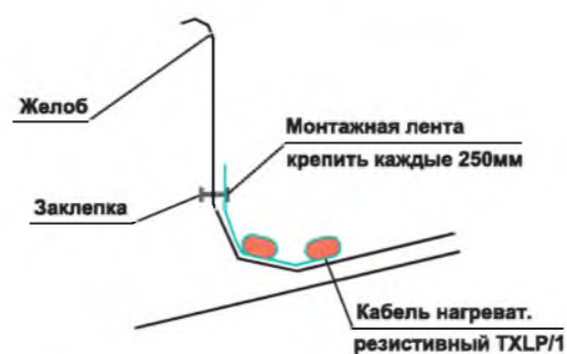
Крепление 2-х ниток резистивного нагревательного кабеля TXLP/1 в желобах
