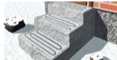
Монтаж одножильного нагревательного кабеля
