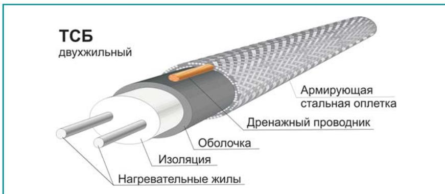
Наружная оплетка обеспечивает механическую прочность, улучшает теплоотвод и выполняет функцию электромагнитного экрана. Дренажный проводник вместе с оплеткой играет роль защитного заземляющего контура. Изоляция
