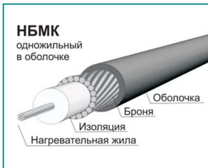
Секции на основе кабеля НБМК для антиобледенительных систем имеют тепловыделение 20 Вт/м.
