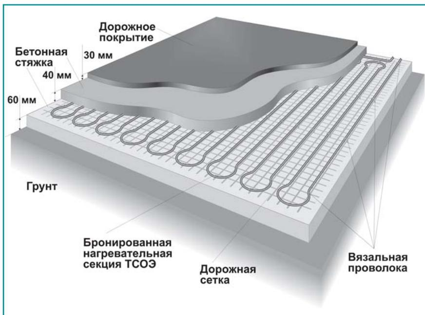
Бетонная стяжка поверх кабелей и дорожное покрытие укладываются после выполнения всех соединений и проверки работоспособности системы). Секции ТСОЭ и ТСБЭ крепятся к основе с помощью отрезков монтажной ленты.
