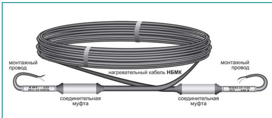
В одножильных нагревательных секциях ТСОЭ используются бронированные нагревательные кабели НБМК в пластиковой защитной оболочке.
